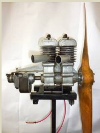
Letecký motor konštrukčne vyvinutý v Považských strojárňach (prvý pokus o zavedenie výroby leteckých motorov na Slovensku), 1949 – 1955
